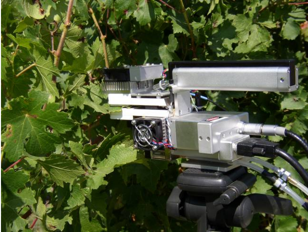
Analizzatore di scambi gassosi ad infrarosso (IRGA) portatile Li-Cor 6400
