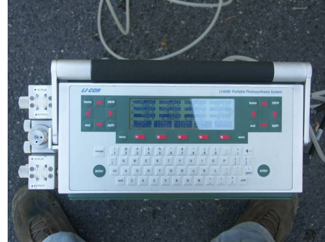
Analizzatore di scambi gassosi ad infrarosso (IRGA) portatile Li-Cor 6400
